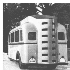
Bild 5. Qualifiziert mit 26 Sitzen und Halbgasanztrieb. Besetzt Prof. Dr. Dörmann. Die Generatoren sind im Heck angebracht und vollständig von einem Schutzblech in der Verkleidung gegen die Luftströmung und gegen Feuchtigkeit geschützt. Einziges für das Bedienungspersonal. Zusätzlicher Schutz vor Regen befindet sich auf dem Dach. Auslass über dem Dach.
